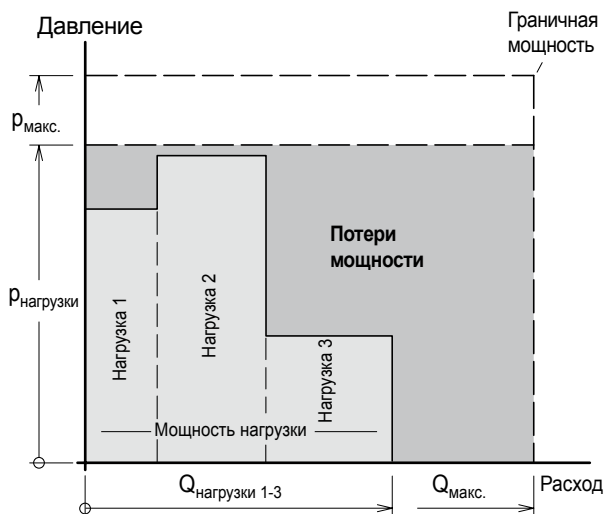
Диаграмма 1. Система с постоянным расходом с нерегулируемым насосом.
